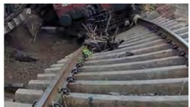
Мал. 15. Наслідки теплого розширення і стискання
