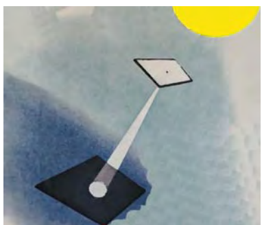
Мал. 85. Вимірювання діаметра Сонця
