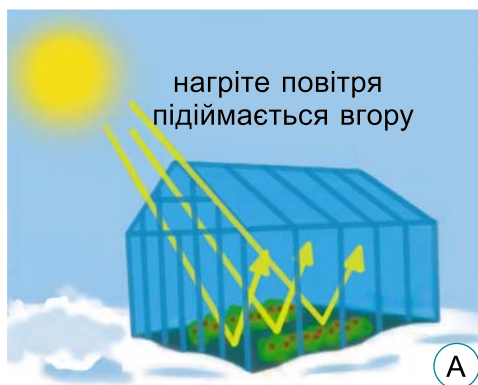
Мал. 223. А. Сонячні промені, проникаючи в теплицю, прогрівають ґрунт. Б. Парниковий ефект
